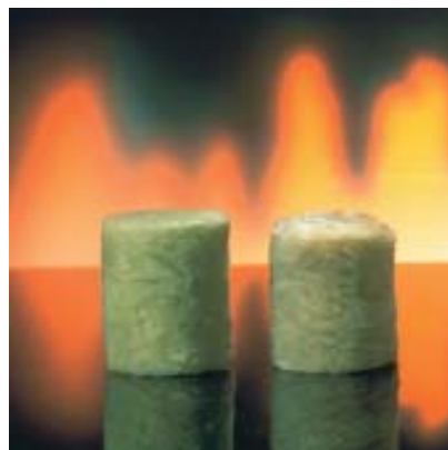
Vlevo vzorek kamenné vlny před zkouškou nehořlavosti, vpravo po zkoušce
